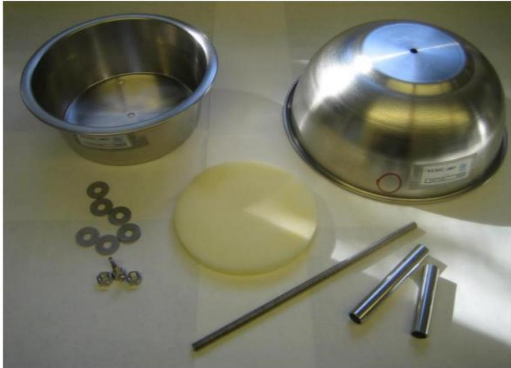
Imagen N° 1. Materiales usados para el muestreo de aire proporcionados por el proyecto
