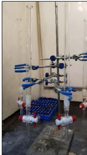
Imagen 10 Columnas de limpieza de extractos de PUFs
