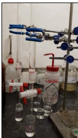
Imagen 23 Limpieza del extracto con columnas de florisil
