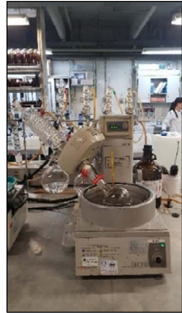
Imagen 9 Rotaevaporación del extracto
