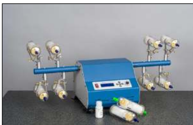
Imagen 20 Equipo de agitación automática
